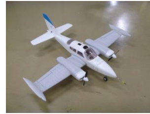
Fig. 4: 飛行中の空力測定に用いた双発模型飛行機
