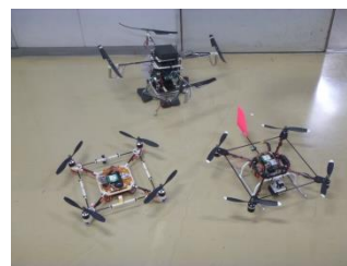
Fig. 16: 自作したQuad-rotors (3号機、4号機、5号機；4号機の赤い羽根は遠くから姿勢を判断できるように付けている；プロペラの直径は8inch)
