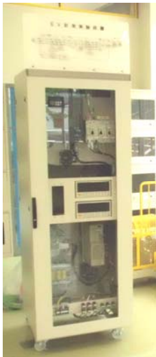
三相交流を生成する装置等が入った制御盤
